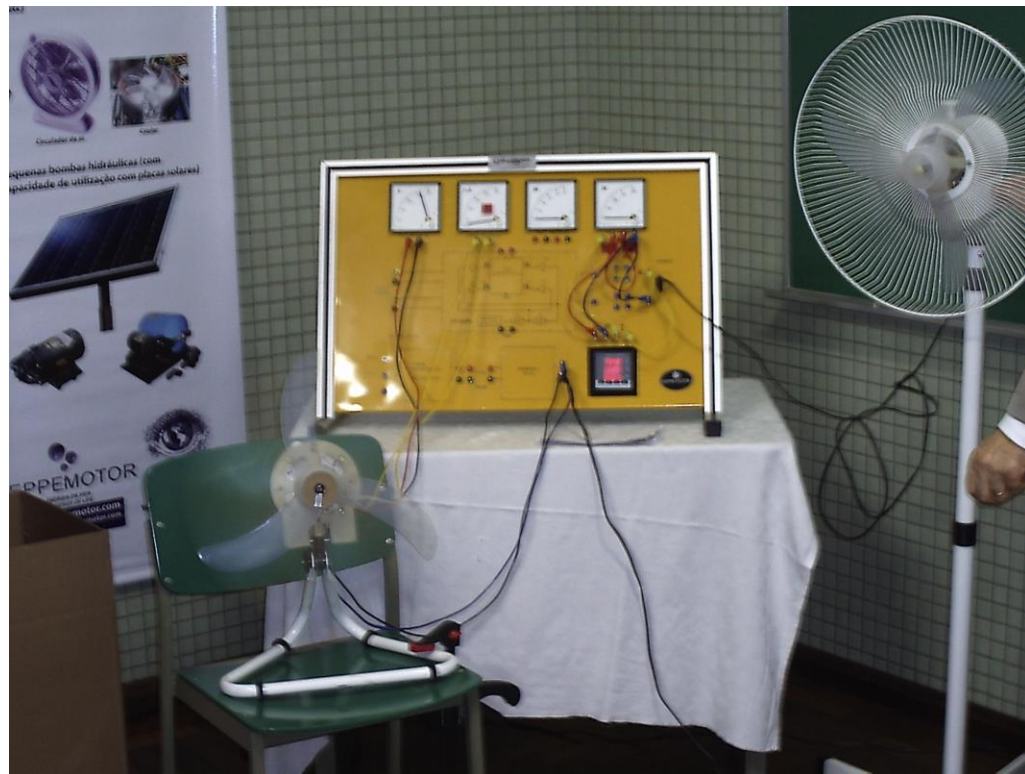
Fig.08 ; Painel didático, fabricado pela De Lorenzo do Brasil- 2011, que analisa a eficiência energética do Keppe Motor , comparando com motores elétricos convencionais ..
