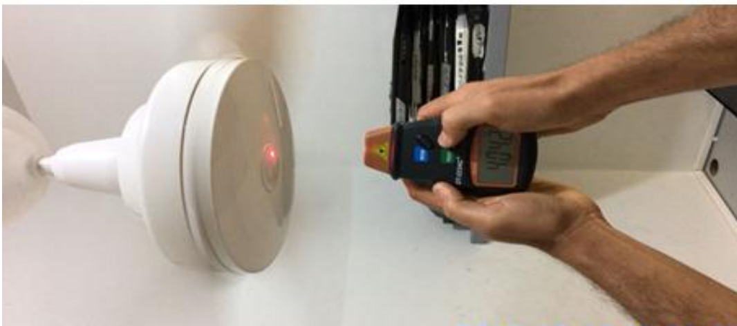
Figura 35 – Medição de rotação no ventilador 2
