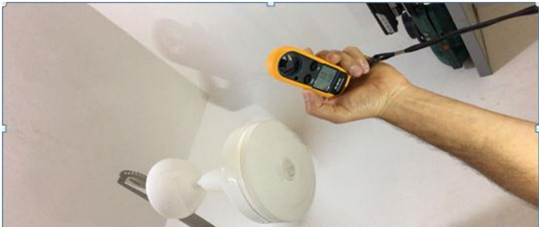
Figura 33 – Medição da velocidade do ar no ventilador 2
