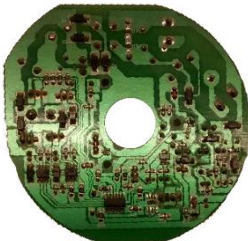
Figura 20 – Vista inferior da placa de circuito integrado do Keppe-Motor®
