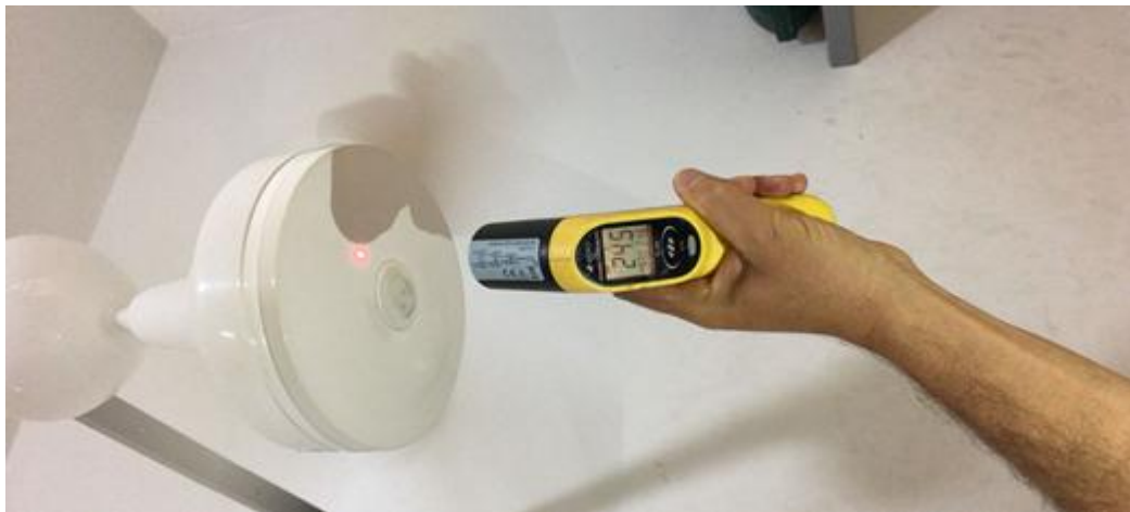
Figura 37 – Medição de temperatura ventilador 1
