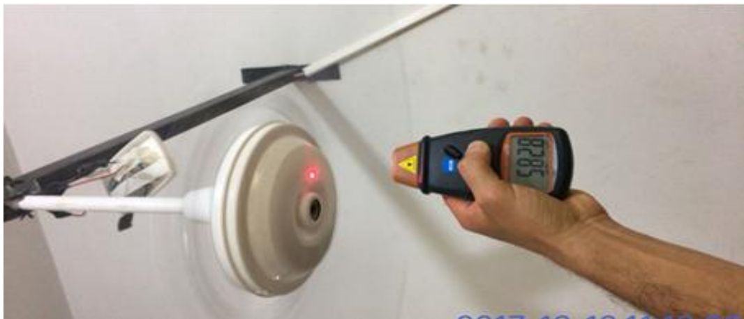
Figura 34 – Medição de rotação no ventilador 1
