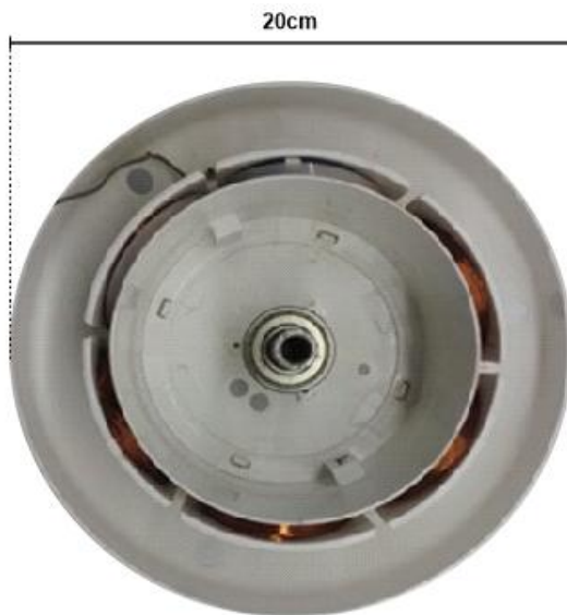
Figura 19 – Bobina eletrostática do Keppe-Motor®
