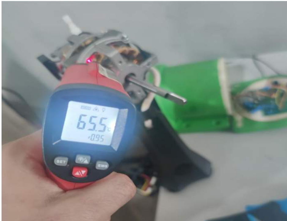
Figura 34- Temperatura do estator do motor de indução.
