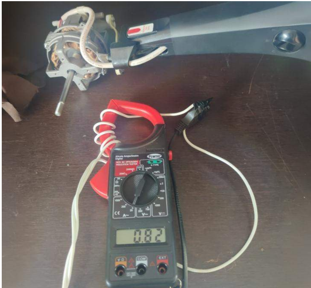
Figura 23- Corrente do motor de indução rodando sem carga.
