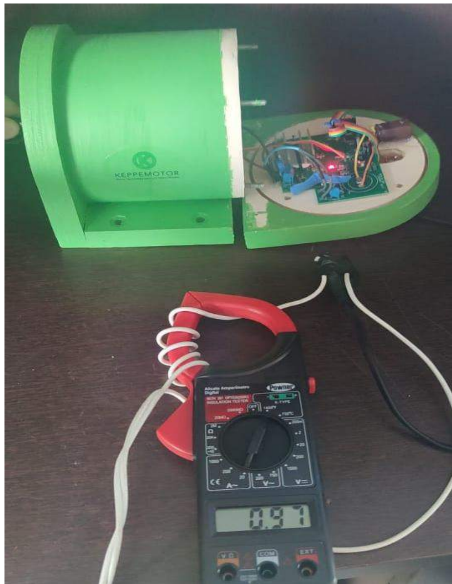
Figura 26- Corrente do motor ressonante Keppe motor rodando com carga.
