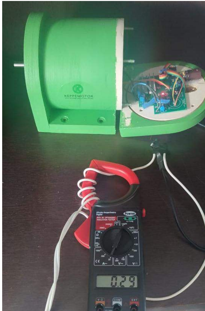
Figura 25- Corrente do motor ressonante Keppe motor rodando sem carga.
