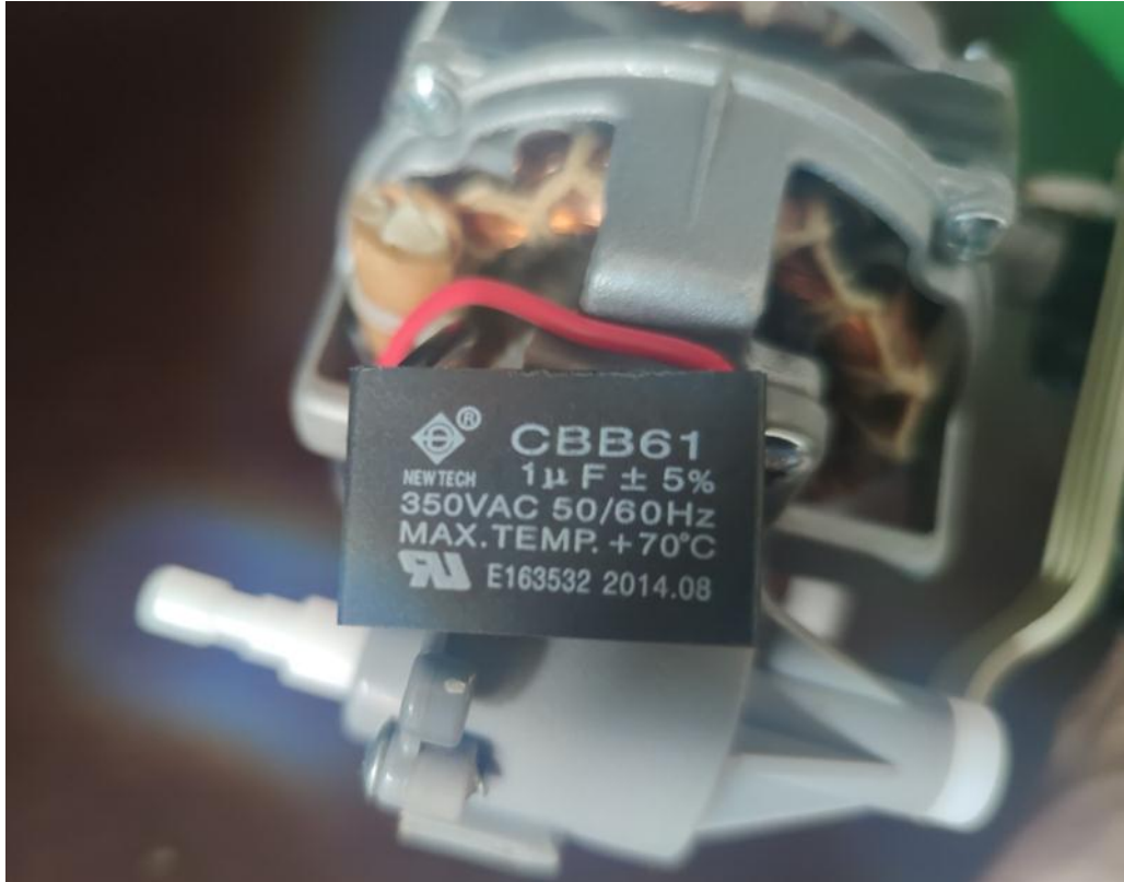
Figura 14- Imagem do capacitor utilizado no motor de indução.
