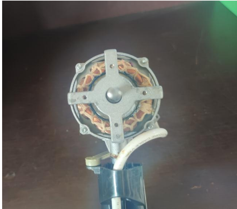
Figura 12- Imagem frontal do motor de indução.
