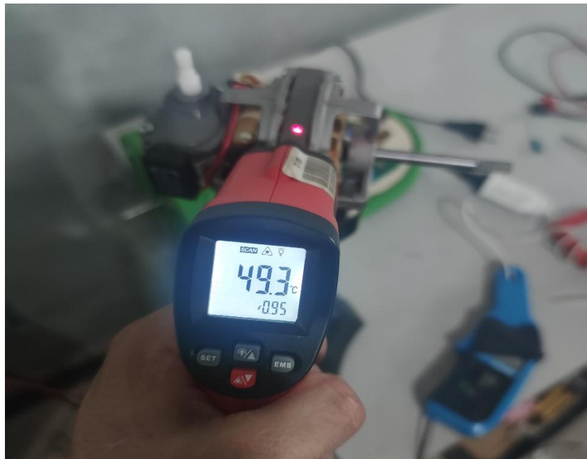
Figura 33- Temperatura do núcleo do estator do motor de indução.
