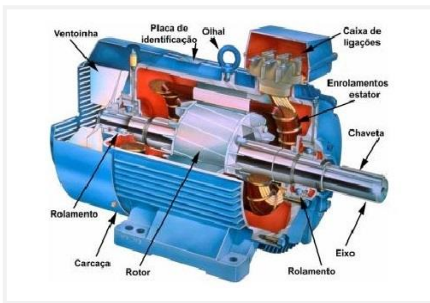
Figura 1 – Componentes de um motor elétrico
