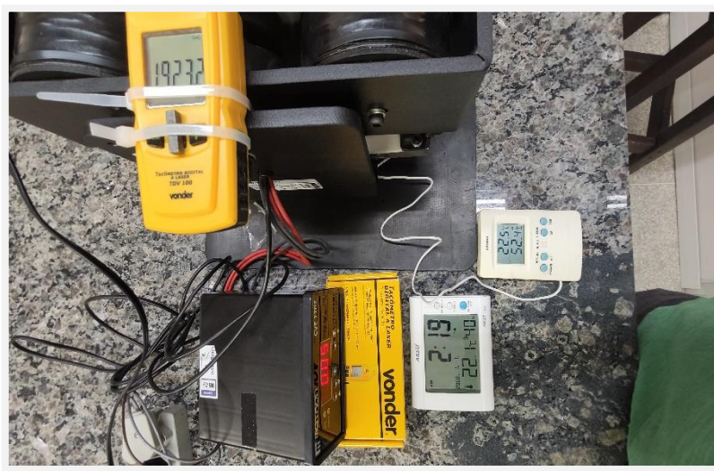
Figura 7 – Ensaio de aquecimento do Keppe-Motor®
